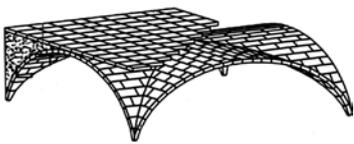
E nei piani superiori invece, troviamo una tipologia di volta, Falsa Volta in Camera Canna, che come precedentemente descritto non contribuisce a resistere alle azioni orizzontali sismiche.
