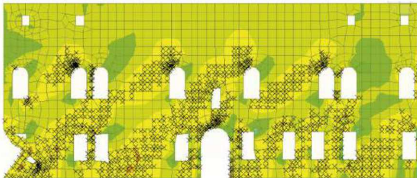
Fig. 20 Simulazione di fessurazioni diagonali.
